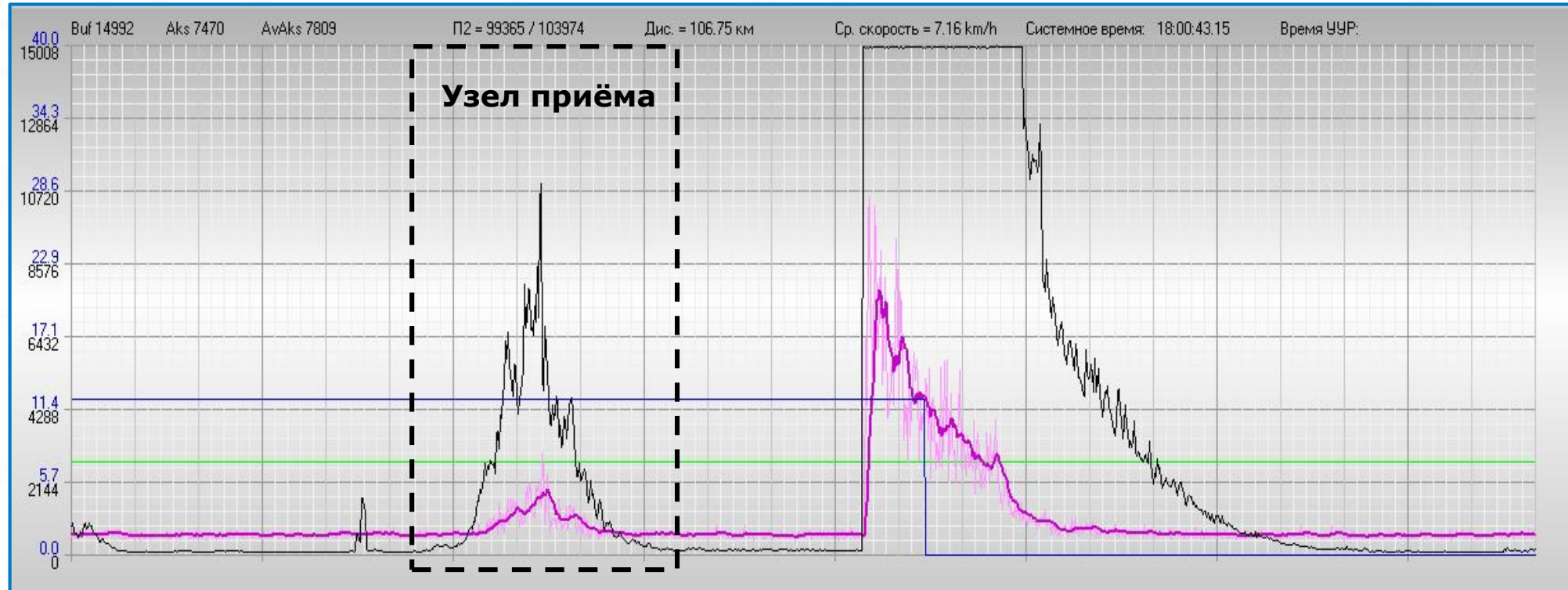
Хронограмма прибытия очистного поршня в узел приёма 0,0 км (19.10.2010 г.)
